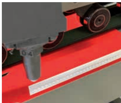
I distributori GTE-13 possono lavorare in modalità punti per risparmiare colla.
