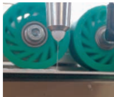
Ancore mobili, sfere e ugello in ceramica garantiscono una lunga durata.
