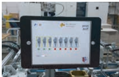
L'iPad è montato su un braccio mobile che permette una facile gestione.
